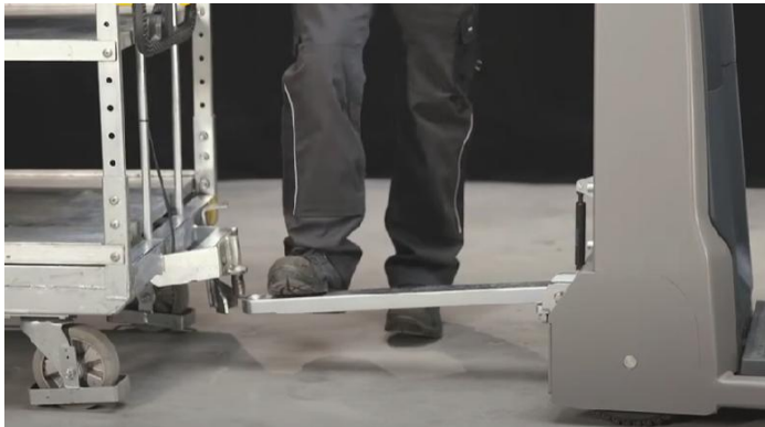
7. Addig nyomjuk amíg a vontatmányon lévő vonószem alá kerül, ekkor kézzel a vontatmányt rá igazítjuk
