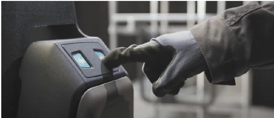
3. A vontatóról leszállva a gép oldalán lévő kezelőszervekkel folytatjuk a tolatást
