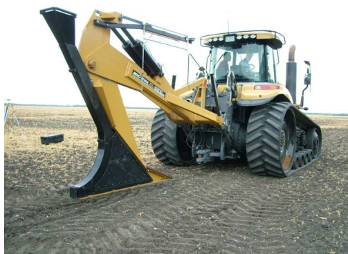
Gumihevederes, nehéz univerzális traktor és alagcsövező rendszer
