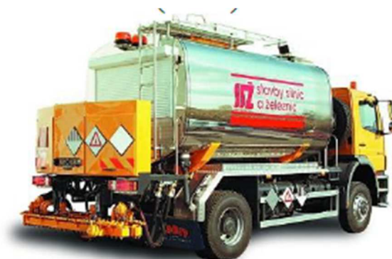
Hordozójárműre szerelt emulziószóró berendezés
