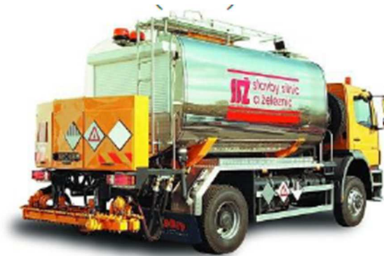
Hordozójárműre szerelt emulziószóró berendezés
